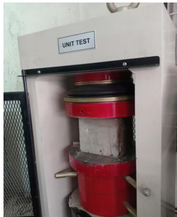
Hình 4: Thí nghiệm nén mẫu bê tông
